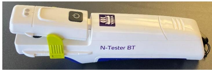
Der **N-Tester BT** hat kein eigenes Display und kann nur in Verbindung mit der App eingesetzt werden. Der bekannte dreistellige N-Tester-Messwert wird Ihnen nach der Messung mit dem N-Tester in der App angezeigt. Diesen können Sie dann wie bisher für das N-Monitoring nutzen.
