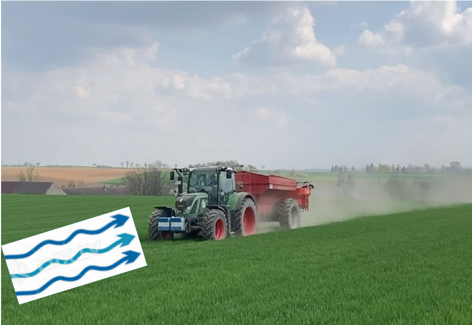
Wind in/gegen Fahrtrichtung führt zu Streifigkeit
